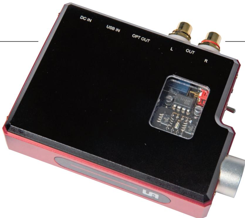
et un Wolfson compatible 24/192 pour la conversion numérique vers analogique. Le filtrage et l'étagage buffer de sortie à base d'amplis opérationnels LME49710 ont bénéficié de l'attention du concepteur particulièrement habile en termes de circuits analogiques. Les composants sont de technologie CMS, d'où la taille lilliputienne du produit.
