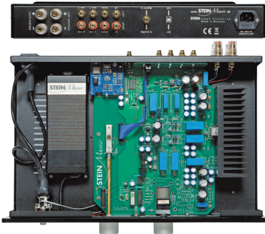
La qualité de fabrication de cet Amp 2 est remarquable pour le prix. Le chip d'amplification est plaqué par une lame métallique au centre du dissipateur.
